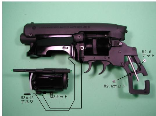
オーバーサイズグリップフレームを取り付けます。ブルドックフレームのグリップ部にM2.6のナットを落とし込みブルドックフレームの突起にトリガーガードの穴を嵌めてからブルドックフレームのグリップに嵌めます。
